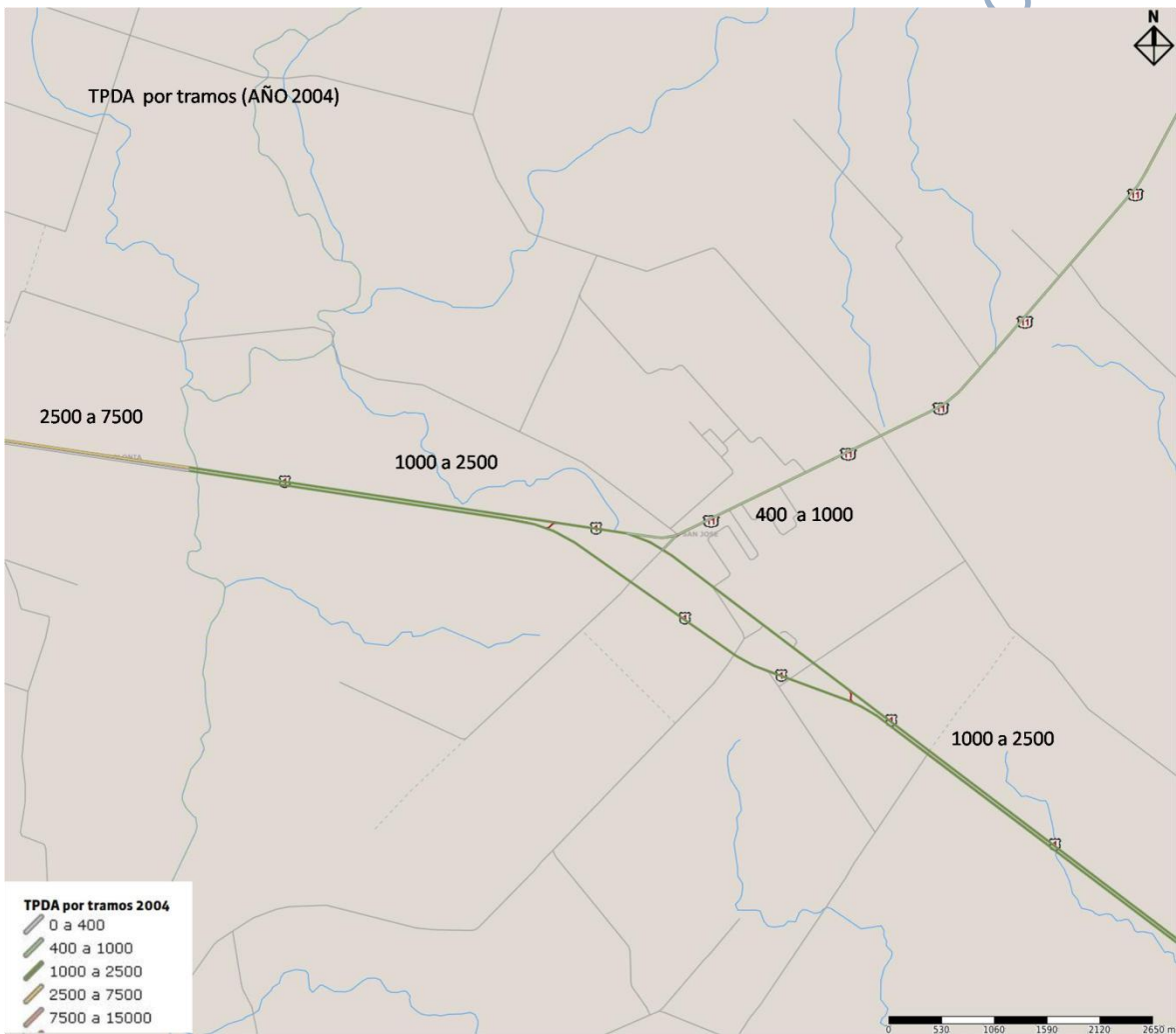
Gráfico 46- TPDA POR TRAMO AÑO 2004, RUTAS 1 Y 11 (Fuente: GEO PORTAL IDE/MTOP, Relevamiento Estadístico de Tránsito)
