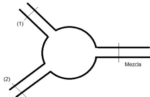
¿Qué gasto másico debe ingresar en (2) para obtener agua tibia a  $45^{\circ}\text{C}$  a la salida (mezcla)?
