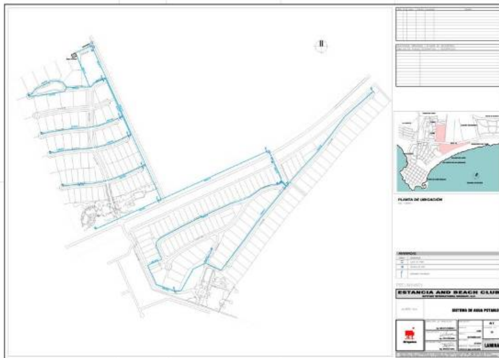
Figura 7. Esquema de la infraestructura de abastecimiento
