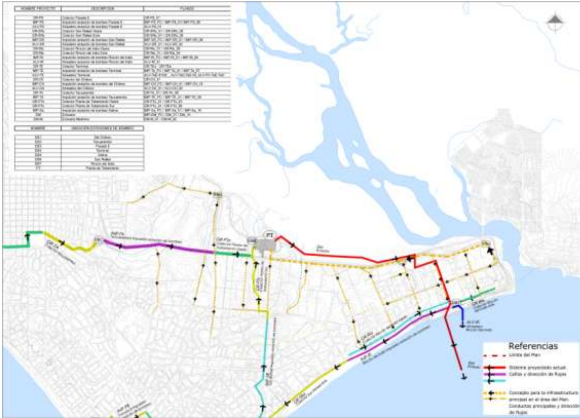
Fig. 26 Red troncal de saneamiento propuesta para el polígono y el sistema actual (Esquema 4)
