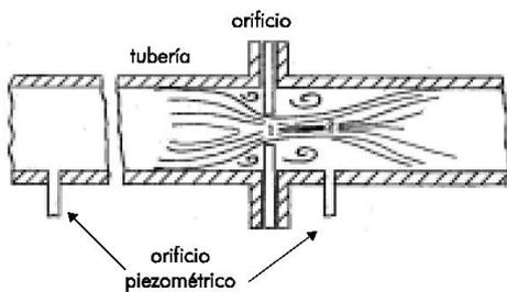
**Fig. 1** Medidor de Orificio
