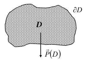
Esfuerzos de Contacto (o Superficie): Aquellos esfuerzos que realiza el resto del universo sobre la frontera (o borde) del VC, a la que denotaremos como  $\partial D$ . Aquí se tienen esfuerzos normales y rasantes a  $\partial D$  en cada punto.
