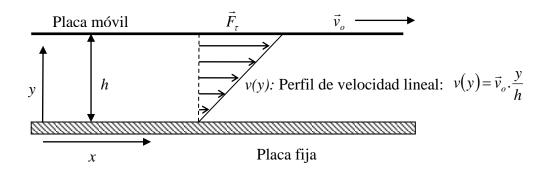
Experimentalmente se demostró que cuando el perfil de velocidad es lineal, la fuerza cortante  $(\vec{F}_{\tau})$  y la tasa de deformación del fluido  $(\vec{v}_o/h)$  seguían la siguiente relación:
