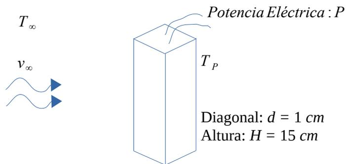
La tabla siguiente muestra resultados de dos ensayos realizados en dos diferentes condiciones de ingreso ( $v_\infty, T_\infty$ , que se miden), en los cuales se provee una potencia eléctrica  $P$  para mantener  $T_p$  en  $25^\circ\text{C}$  de la cual se estima que un 5% se pierde al exterior por efectos de conducción longitudinal.
