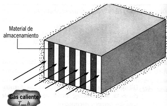
Considere condiciones en las que la unidad de almacenamiento se carga con el pasaje de un gas caliente a través de las rejillas con  $T_{\infty} = 600^{\circ}\text{C}$  y  $h = 100\text{W/m}^2\text{K}$ .
