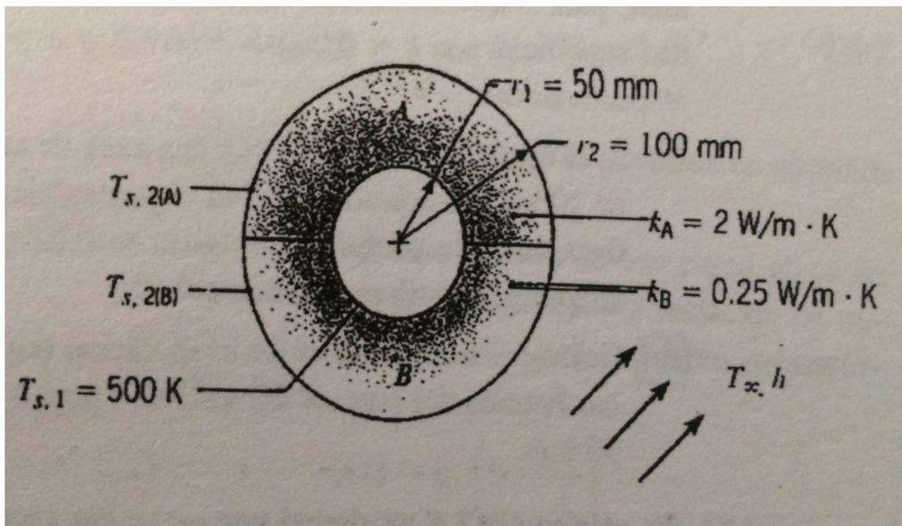
Se supone que la interfaz entre los dos materiales tiene una resistencia de contacto infinita y que toda la superficie externa está expuesta al aire, para el cual  $T_{\infty} = 300^{\circ}\text{K}$  y  $h = 25\text{ W/m}^2\text{ K}$ .
