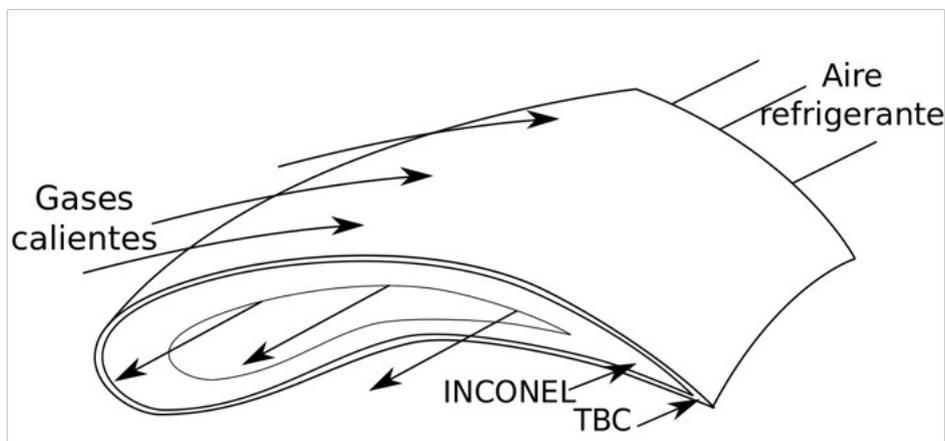
Por lo común la pala está fabricada de una superaleación de alta temperatura como INCONEL ( $k = 25\text{W/mK}$ ) mientras que como revestimiento de barrera térmica se usa CIRCONIA ( $k = 1.3\text{W/mK}$ ).
