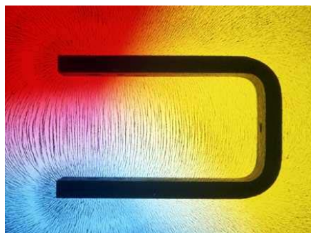
Figura 7- Líneas de fuerza magnéticas El campo magnético de un imán de herradura se pone de manifiesto por la distribución de las limaduras de hierro, que indican la intensidad y dirección del campo en cada punto.
