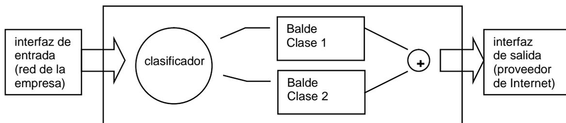
Se asume que existe un mecanismo de clasificación en el enrutador que distingue cada una de estas clases de tráfico y las vuelca en mecanismos como los explicados en a) que conforman en tráfico de modo que a la salida de cada balde tiene los siguientes parámetros:
