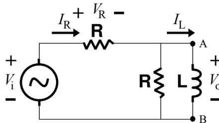
El circuito de la figura se alimenta con una fuente  $v_i = V \cdot \cos(\omega_0 t)$ .
