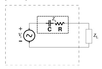
El circuito de la figura esta alimentado por una fuente real sinusoidal que trabaja a una frecuencia  $\omega_0$ , la cual vamos a modelar como una fuente ideal en seria con impedancia  $Z_S = R_S + jX_S$ .
