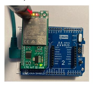
Este módulo acepta dos antenas; una antena para la conexión celular (larga y rígida) que va colocada en el conector CN1, y una antena secundaria para la geolocalización (cuadrada y con cable) que va colocada en el conector CN2.
