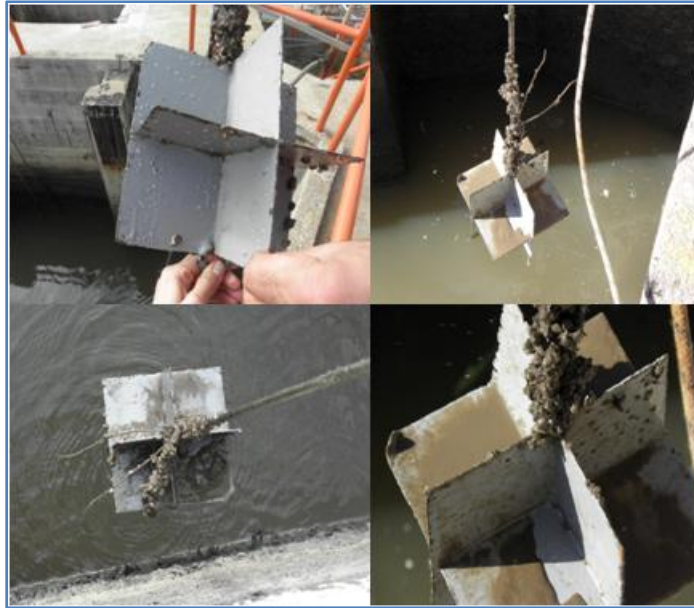
Figura10. Paneles de incrustación en la pileta de captación de agua para el sistema de refrigeración de la refinera La Teja. Izquierda: junio 2010, derecha, julio 2010. Ausencia de macrofouling sobre estructuras pintadas con Hempasil 77500.
