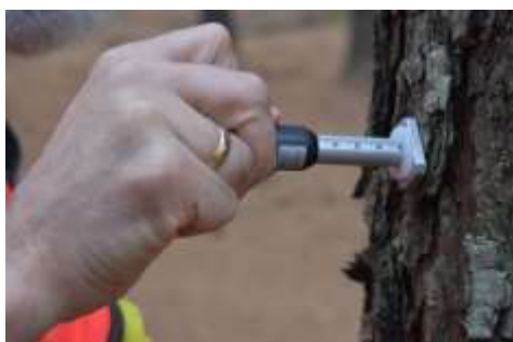
Calibrador de corteza Barktax de Haglöf.
