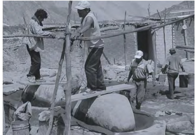
'Quimbalete' – Molino de amalgamación para la minería en pequeña escala en el Perú
