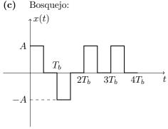
Cuando se conforma con pulsos rectangulares con retorno a cero, se requiere mayor ancho de banda (los pulsos duran menos tiempo) pero se envía implícitamente una señal de sincronismo y la señal enviada es de menor potencia.
