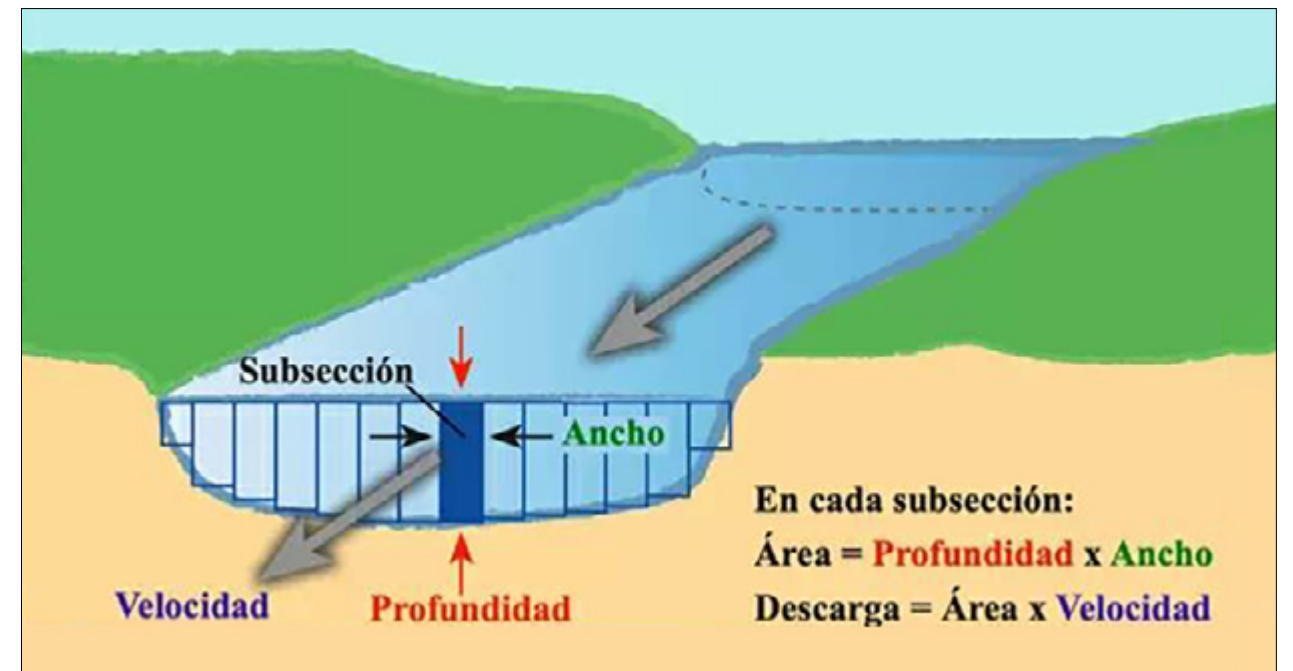
Figura 3: Esquema de la sección de un río establecida a partir del ancho y la profundidad, que multiplicada por la velocidad del agua indica el caudal.
