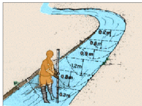
Figura 2: Posicionamiento de las transectas en un tramo del río para determinar su ancho.
