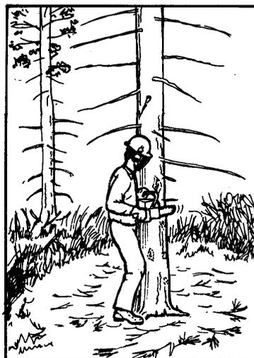
El operario debe respetar la posición adecuada, descendiendo al lugar de corte flexionando las rodillas y manteniendo la espalda recta, lo cual facilitará el trabajo y evitará un cansancio prematuro lo cual disminuye el rendimiento. Al realizar el corte los codos se deben apoyar en las piernas, con lo cual se compartirá mejor el peso de la motosierra y se mejorará la precisión del corte.
