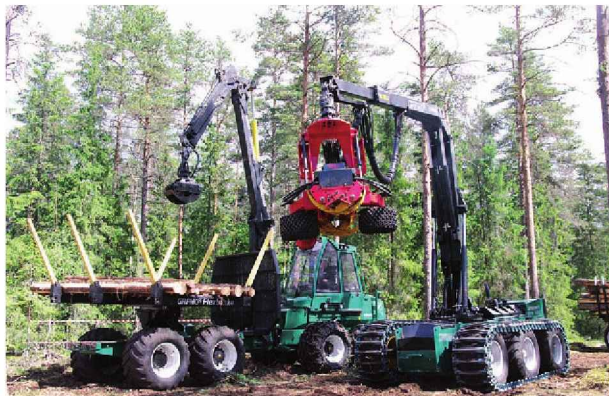
Figura 3.6. Prototipo de cosechadora con control a distancia (sin maquinista ni cabina) desarrollado por Besten. Detrás, se encuentra el autocargador que es controlado por el mismo maquinista
