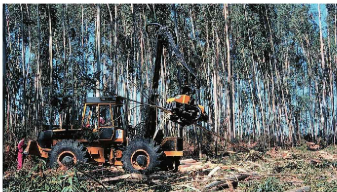
Figura 3.4. Diseño de cosechadora basado en chasis de autocargador
