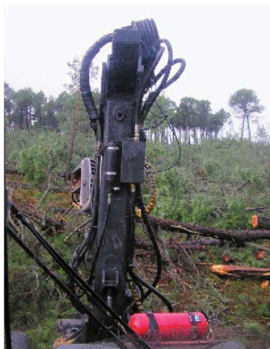
Figura 3.77. Tubos y latiguillos de la grúa de una cosechadora
