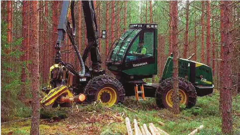
Figura 3.5. Diseño específico de máquina cosechadora con motor y (cabina + grúa) en diferentes semichasis
