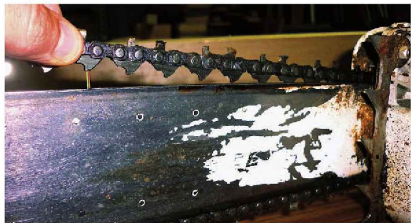
Figura 2.17. Comprobación de la tensión de la cadena
