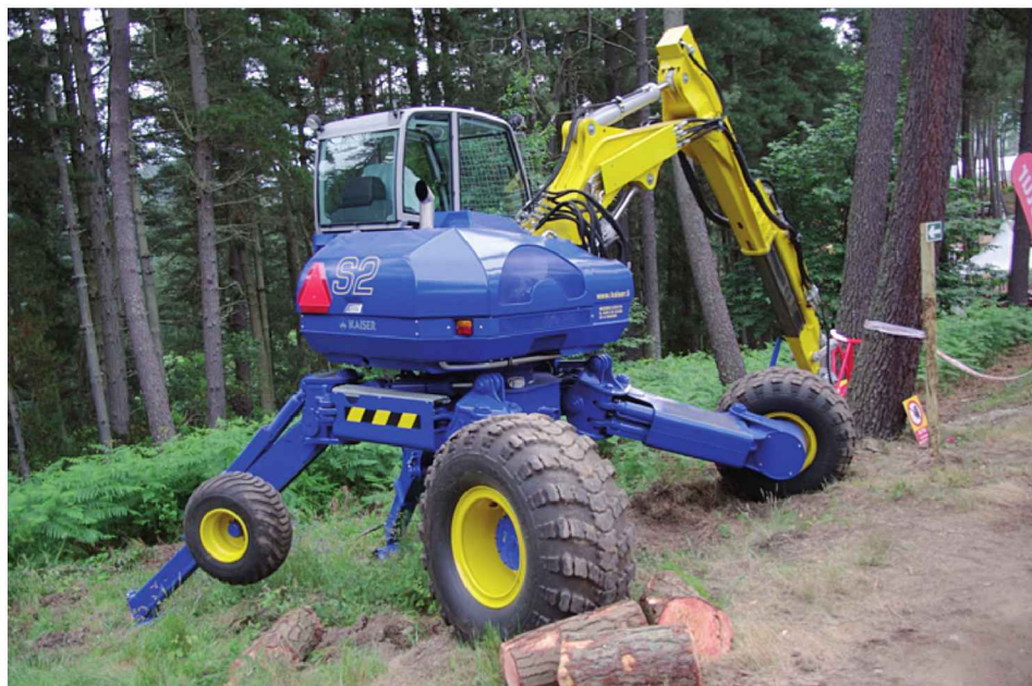
Figura 3.11. Cosechadora sobre retro-araña para trabajo en pendientes muy altas
