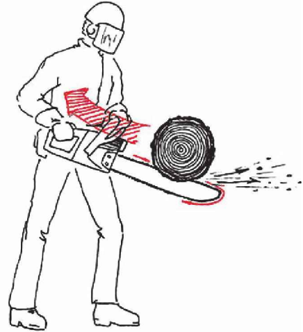
Figura 2.78. Modalidad de corte con la cadena empujando
