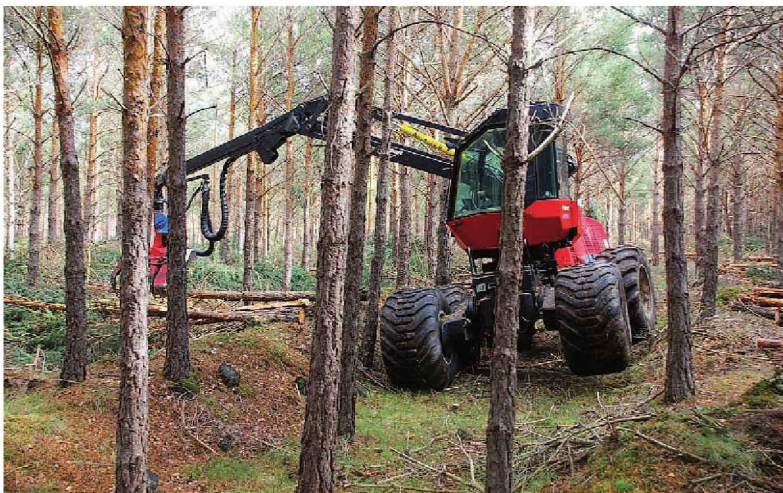
Figura 3.48. Cosechadora convencional trabajando en un sistema de árboles completos o partes de árbol
