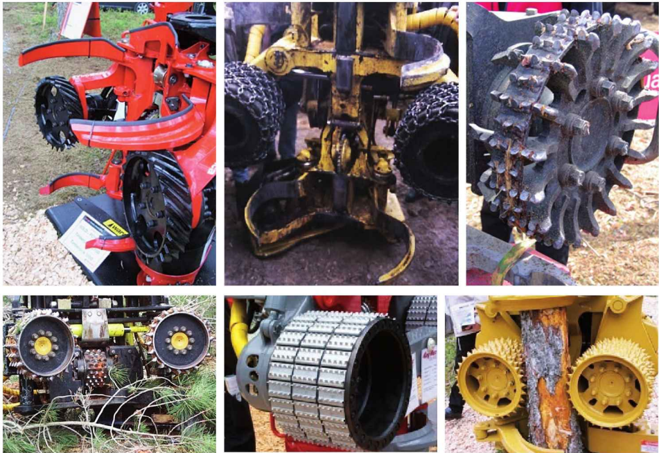
Figura 3.22. Distintos tipos de rodillos de alimentación (Fotografías: E. Tolosana)
