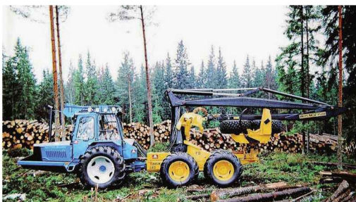
Figura 3.3. Antigua cosechadora de cabezal de apeo y plataforma de procesado ( two-grip harvester )
