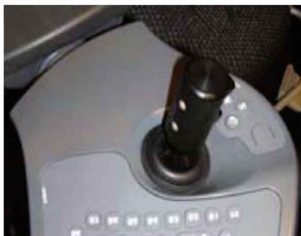
Figura 4.27. Joystick de control de dirección en tractor forestal
