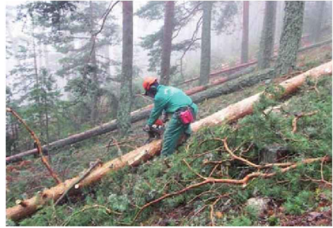
Figura 2.93. Motoserrista trabajando con la motosierra demasiado separada del cuerpo
