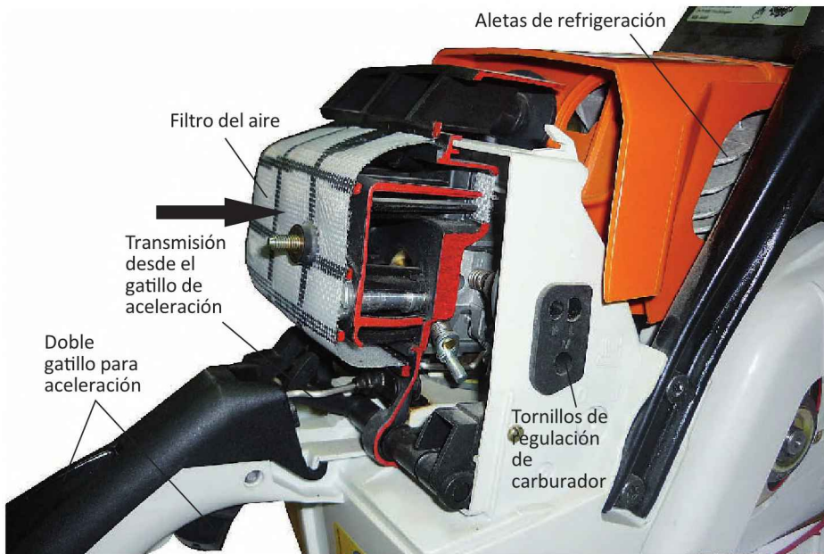
Figura 2.147. Detalle de la entrada del aire al carburador
