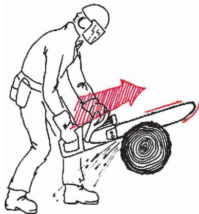
Figura 2.77. Modalidad de corte con la cadena tirando. Las flechas representan la dirección del esfuerzo del motoserrista
