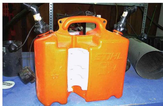
Figura 2.162. Bidón con sistema anti-rebose
