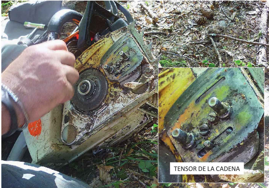
Figura 2.16. Detalle de los espárragos de sujeción y del tornillo de tensión
