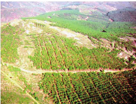
Figuras 2.30 y 2.31. Trazado de calles en línea de máxima pendiente y visión conjunta de límites de parcela, pistas o vías de saca
