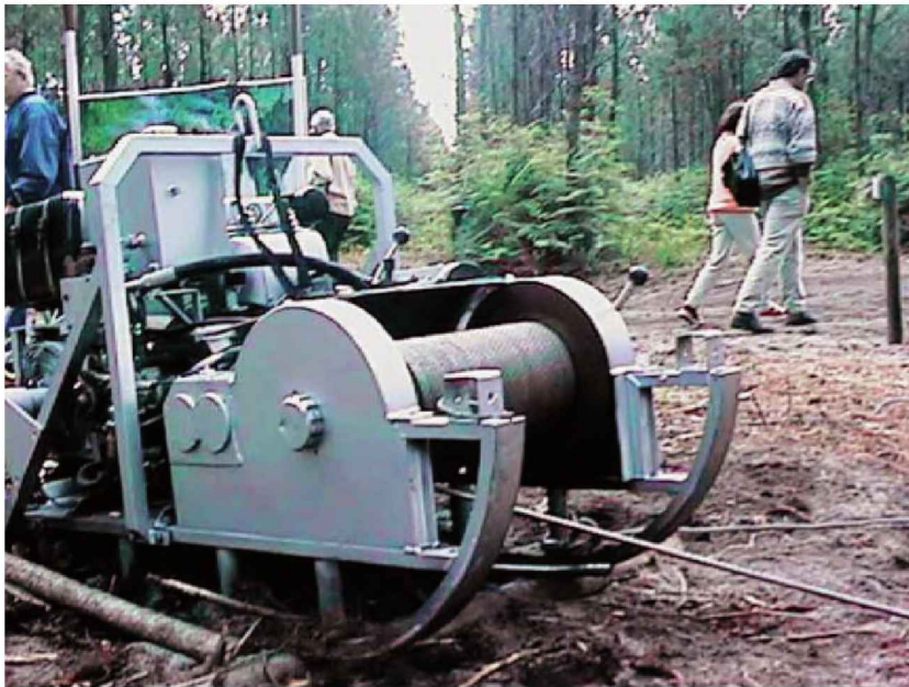
Figura 4.72. Grupos motrices: motriz autoportante, tipo trineo
