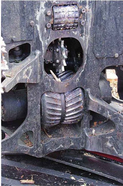
Figura 3.63. Rodillo de medición de la longitud en un cabezal cosechador (se trata de la delgada rueda dentada en el centro de la foto)
