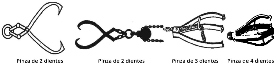
Figura 4.56. Sistemas de enganche para la saca con tractor de arrastre
