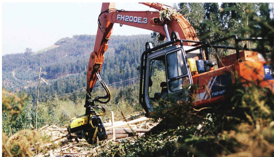
Figura 3.7. Cosechadora sobre retroexcavadora para trabajo en cortas a hecho en terrenos no accidentados, o desde pista o cargadero
