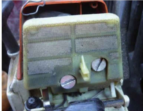
Figura 2.146. Filtro obturado por polvo de serrín
