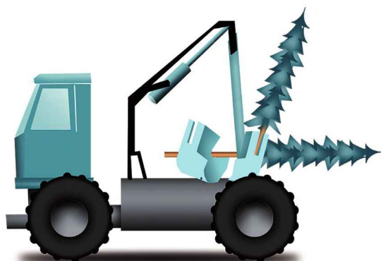
Figura 3.32. Esquema de procesadora móvil trabajando
