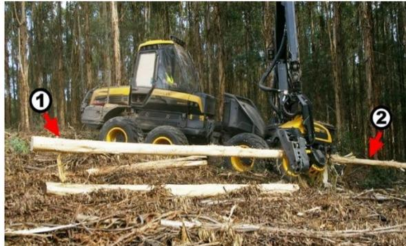
*Figura 7 – Harvester realizando descortezado*
