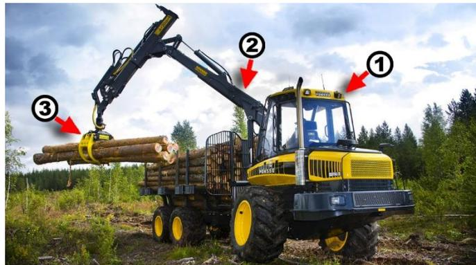
Figura 12 – Componentes principales de un Forwarder
