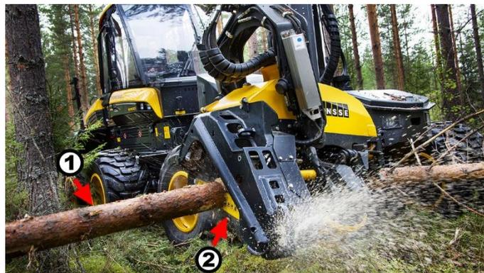
*Figura 10 – Harvester trozando fuste*
