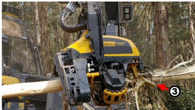
*Figura 8 – Detalle de descortezado*
