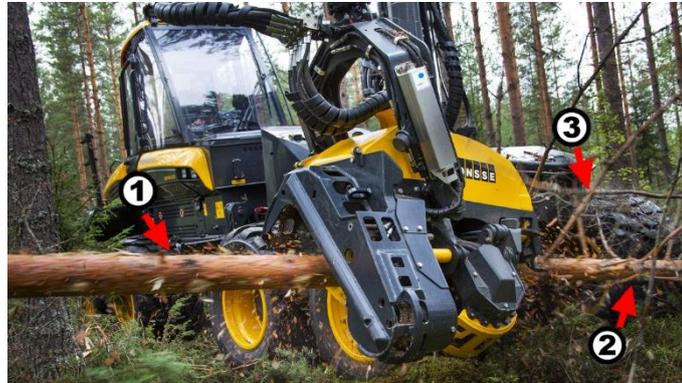
*Figura 9 – Harvester realizando desramado*
