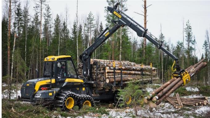
*Figura 16 – Forwarder cargando trozas*
