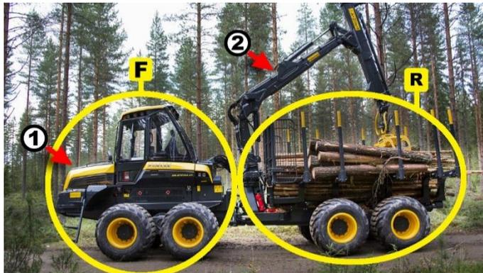
Figura 20 – Parte delantera y trasera de un Forwarder.
