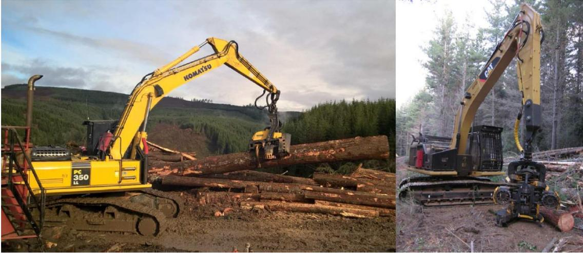
*Figura 11 – Excavadoras con cabezal PONSSE.*
