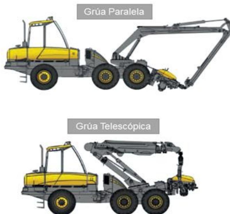
Figura 5 – Grúa Paralela/Telescópica
