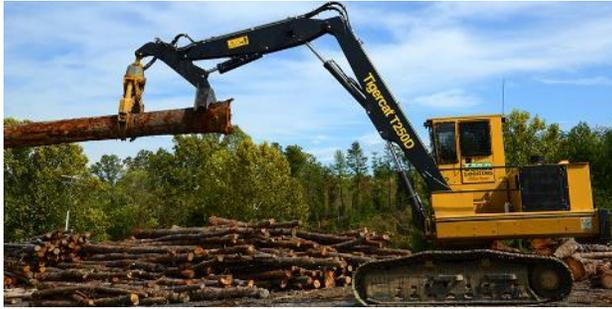
**Figura 17. Carregador mecânico com esteira.**
