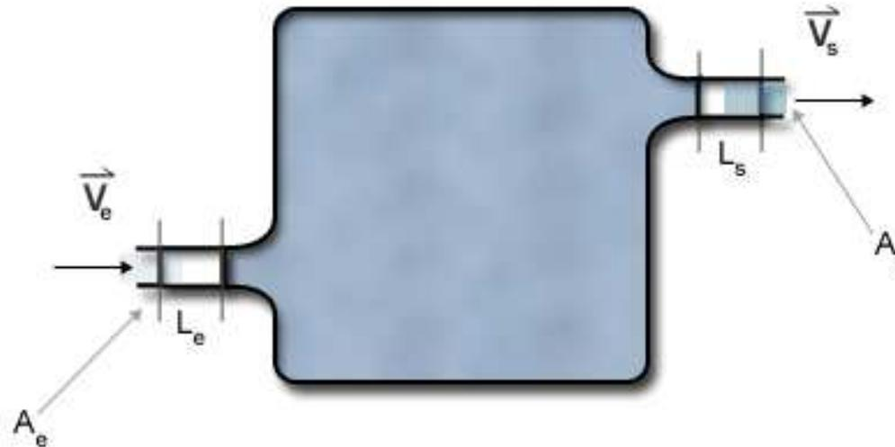
En un tiempo  $dt$ , sale del volumen de control un elemento de fluido  $dm_s$  y el sistema realiza trabajo para expulsar el fluido a una tasa [sigue]
