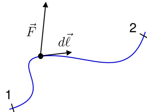
En Termodinámica, es fácil asociar éste trabajo al desplazamiento cuasiestático de una parte de la superficie de control (trabajo de frontera).
