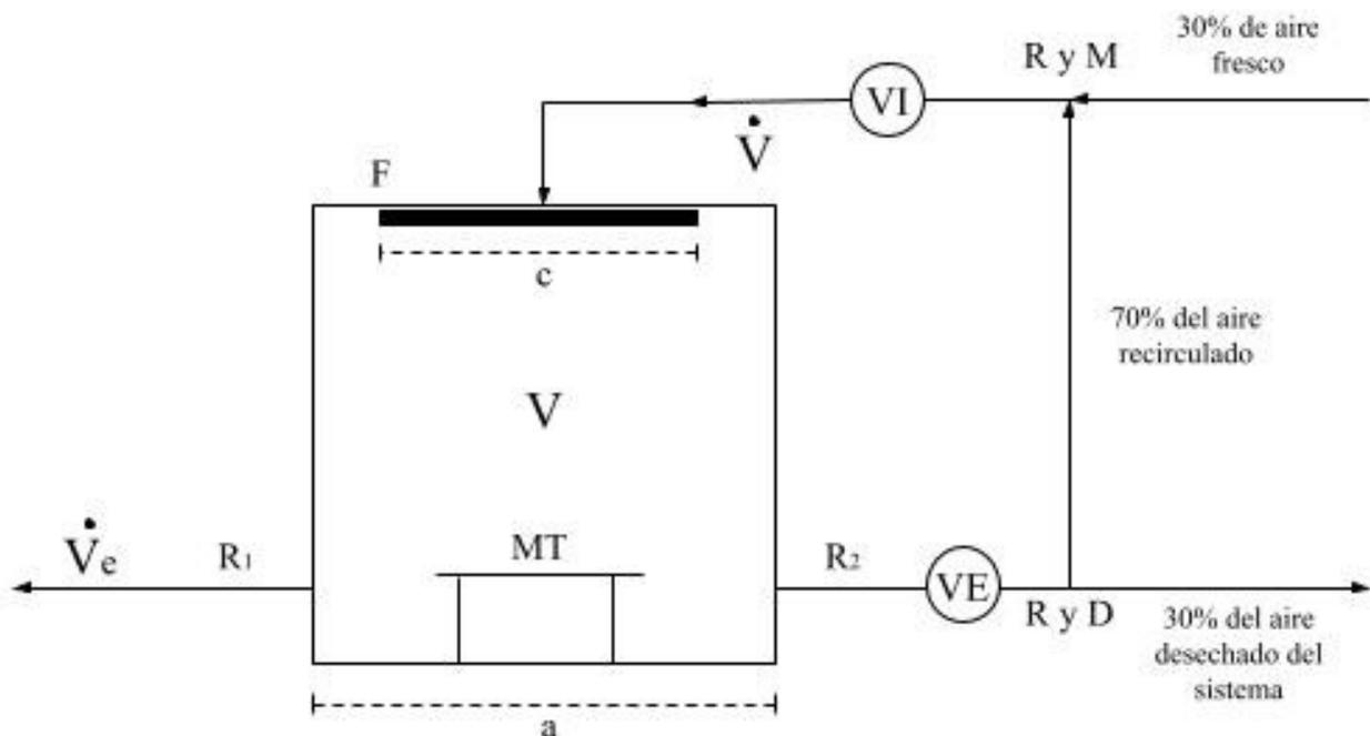
Esquema 1 - Diagrama esquemático de la instalación de aire para un laboratorio
