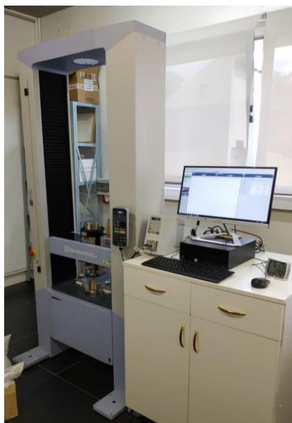
Figura 47. Máquina de ensayos Shimadzu AGS-100.
