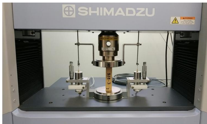
Figura 50. Ensayo de compresión paralela a la fibra.
