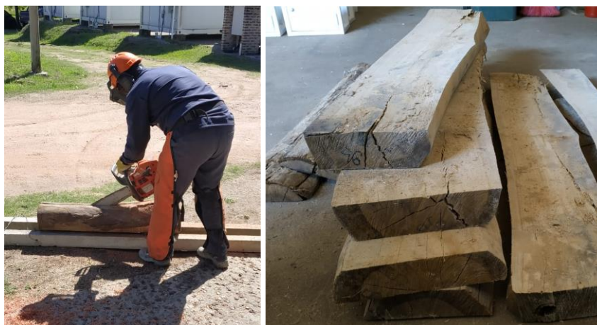
Figura 38. Izquierda: corte con motosierra. Derecha: tablas resultantes del corte con aserradero móvil.
