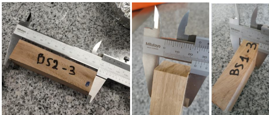
Figura 45. Medición de las dimensiones de las probetas con calibre.
