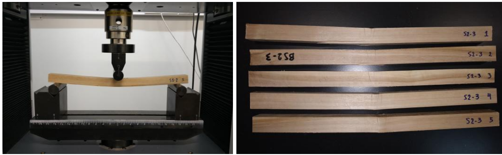
Figura 63. Izquierda: probeta durante ensayo de flexión. Derecha: resultado del ensayo de flexión.
