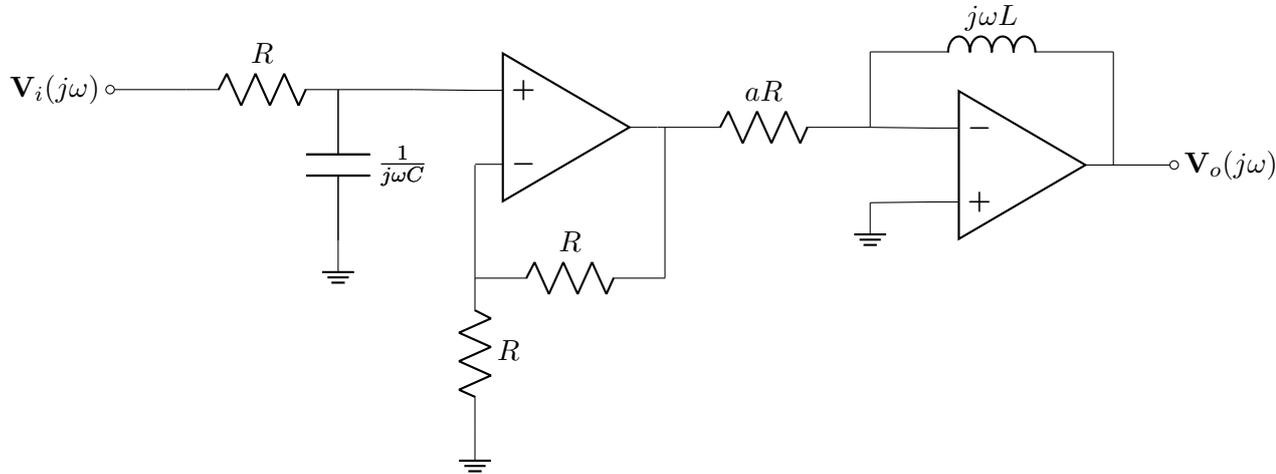
(b) La tensión en la pata (+) del primer A.O. es  $V_+ = \frac{V_i(1/cjw)}{R+(1/cjw)} = \frac{V_i}{RCjw+1} = \frac{(Vi/RC)}{jw+1/RC}$ . Por cortocircuito virtual,  $V_+ = V_-$ . Sabiendo que no entra corriente en la pata (-) del A.O. y  $V_{o1}$  la salida:
