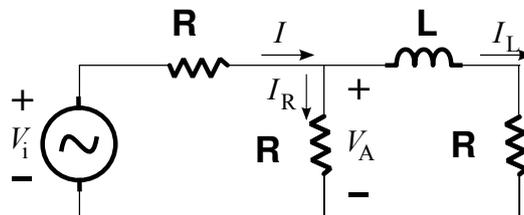
El circuito de la Figura 1 se alimenta con una fuente sinusoidal de la forma  $V_i \cos \omega_0 t$ .
