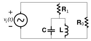
(a) Calcular los fasores  $I_0$  (corriente por  $R_0$ ),  $I_1$  (corriente por  $R_1$ ),  $I_L$  (corriente por L),  $I_C$  (corriente por C) e I (corriente entregada por la fuente).
