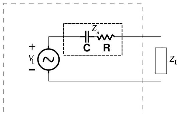
El circuito de la figura esta alimentado por una fuente real sinusoidal que trabaja a una frecuencia  $\omega_0$ , la cual vamos a modelar como una fuente ideal en serie con impedancia  $Z_S = R_S + jX_S$ .
