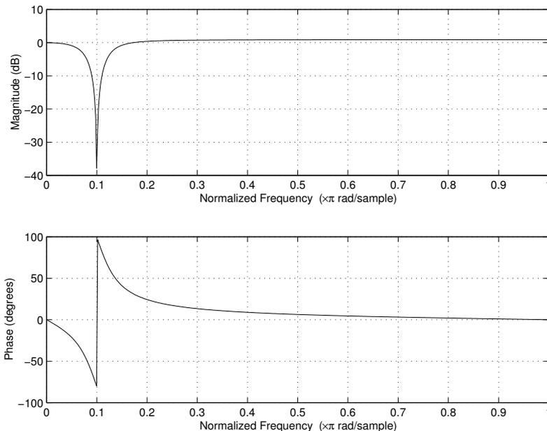
(c) Como vimos en las gráficas de la respuesta en frecuencia, el filtro funciona como un suprime banda en una frecuencia que es parametrizable según  $\theta_0$ . Podemos analizar cómo funciona el filtro observando los polos y ceros del filtro en el plano complejo. El filtro funciona introduciendo dos ceros en la circunferencia unidad, de manera de eliminar las componenetes de frecuencia
