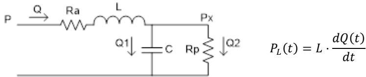
$$Q(t) = \frac{P(t) - P_L(t) - P_x(t)}{R_a} \rightarrow P_x(t) = P(t) - L \cdot \frac{dQ(t)}{dt} - Q(t) \cdot R_a$$
