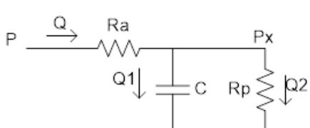
$$Q(t) = \frac{P(t) - P_x(t)}{R_a} \rightarrow P_x(t) = P(t) - Q(t) \cdot R_a$$
