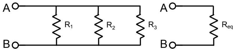
Figura 4:  $R_{eq} = \frac{R_1 R_2 R_3}{R_1 + R_2 + R_3}$
