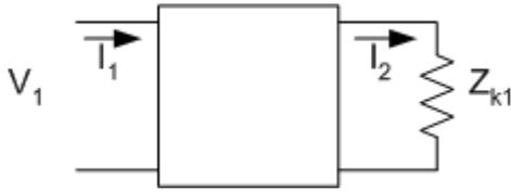
$$\begin{cases} V_1 = AV_2 + BI_2 \\ I_1 = CV_2 + DI_2 \end{cases} \quad \begin{cases} V_2 = Z_{k1} I_2 \\ V_1 = Z_{k1} I_1 \end{cases}$$
