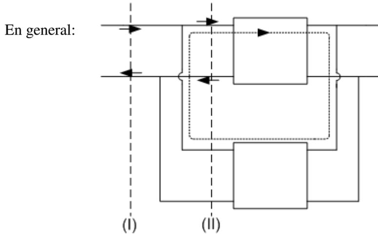
En la sección (I), KCL da la condición de corrientes para el cuadripolo global.
