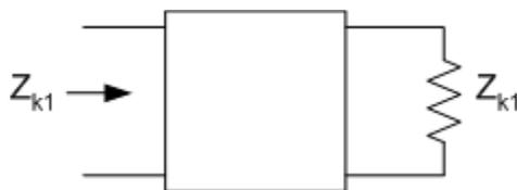
Si pongo  $Z_{k1}$  como carga del primario, para el primer cuadripolo es como si estuviera cargado por la cadena infinita.
