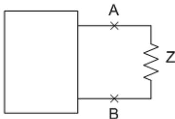
Se trata de calcular la corriente que circula por esa impedancia, sin resolver todo el circuito.
