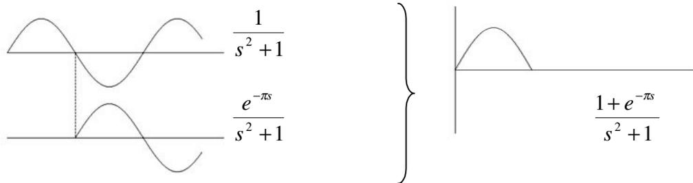
Obtenida la de
