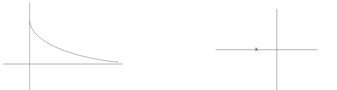
La senoide amortiguada  $Ye^{-\sigma t} \text{ sen } \omega t \rightarrow \frac{\omega}{(s + \sigma)^2 + \omega^2}$  Polos:  $-\sigma \pm j\omega$
