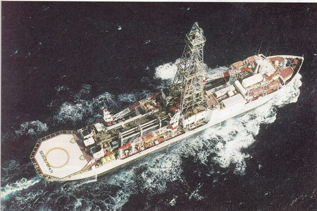
Figura 19.27 El JOIDES Resolution , el buque para realizar sondeos del Ocean Drilling Program. Este moderno buque perforador ha sustituido al Glomar Challenger en el importante trabajo de tomar muestras de los fondos de los océanos mundiales. (Foto cortesía de Ocean Drilling Program).
