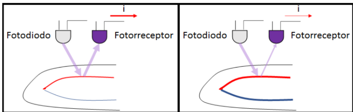
Figura 1: Esquema de un fotopletismógrafo y su principio de funcionamiento.
