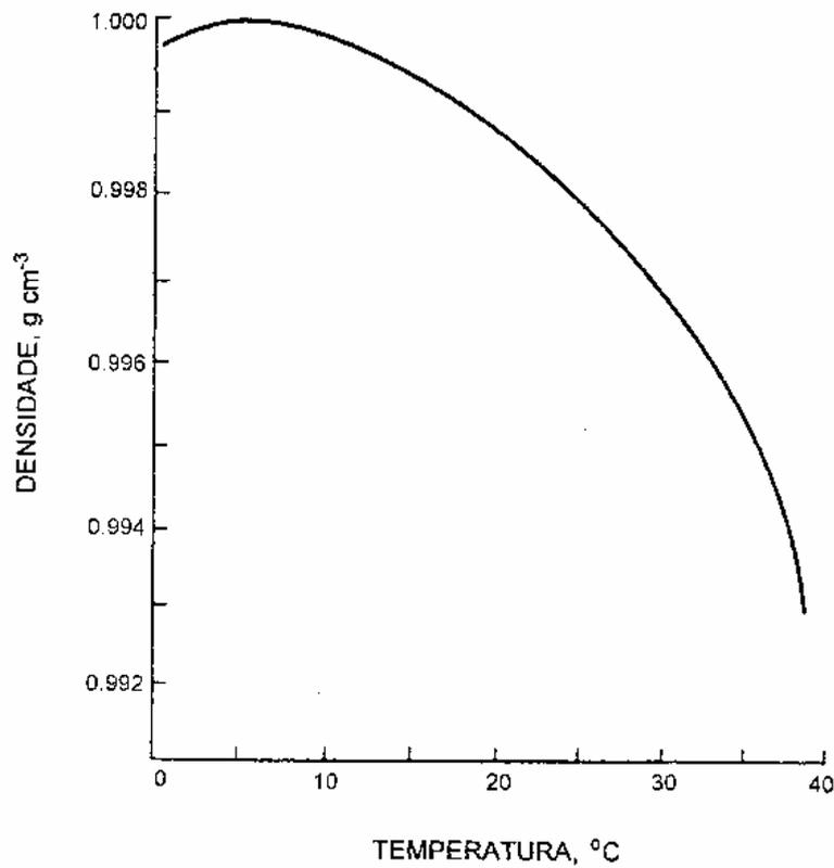
**Fig. 8.4** - Relação entre a densidade e temperatura da água. Observe que o máximo de densidade da água é próximo de 4°C (3,94 °C) e que o decréscimo dos valores de densidade é praticamente exponencial em valores elevados de temperatura
