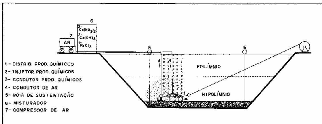
Fig. 25.8 - Recuperação por meio de oxidação química do sedimento Segundo RPL (1976, apud TILZER, 1979)
