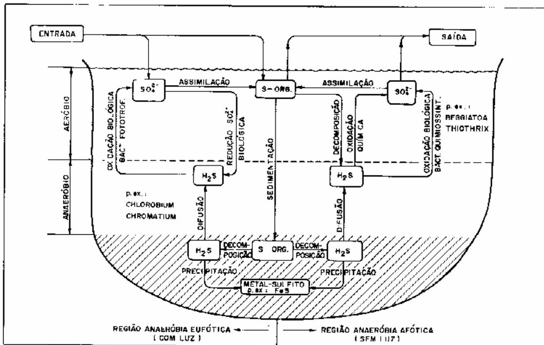
Fig.15.1-Principais transformações do enxofre na água. Modificado de KUSNETZOW (1959) e STEINBERG & MELZER (1982)
