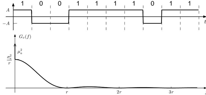
(d) La señal PCM tiene un componente de continua producto de que los símbolos no son equiprobables y por lo tanto,  $\mu_a \neq 0$ . Este nivel de continua se manifiesta en el espectro mediante la delta en continua y como no lleva información, significa un desperdicio de potencia. Para evitarlo, la media de los símbolos debe ser nula, y eso se logra con probabilidad de símbolos  $p = 1/2$ , como se ve en la ecuación 5.
