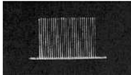
Foto de un analizador de espectro con una señal FHSS. Fuente: [www.sss-mag.com/ss.html](http://www.sss-mag.com/ss.html)
